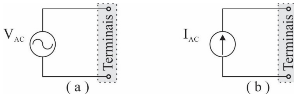
Figura 6.2 – Simbologias das fontes CA: (a) fonte de tensão CA; (b) fonte de corrente CA
