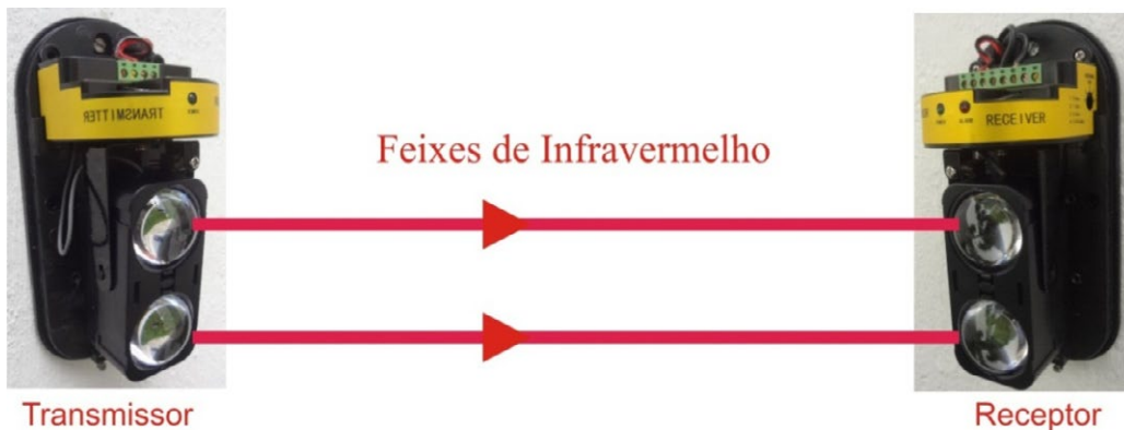
Figura 11.17 – Sensor de barreira com feixe duplo de infravermelho
