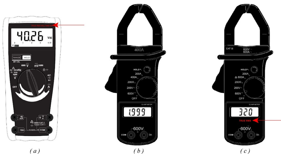
Figura 10.18 – Instrumentos utilizados na medição: (a) multímetro RMS verdadeiro, (b) alicate amperímetro baseado na média, (c) alicate amperímetro RMS verdadeiro
