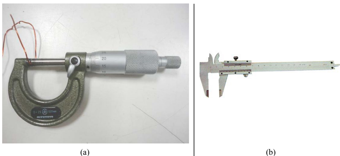
Figura 2.23 – (a) Micrômetro medindo o diâmetro de um condutor de cobre; (b) Paquímetro
