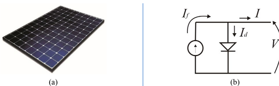
Figura 12.12 – (a) Painel Fotovoltaico comercial monocristalino de 330 watts; (b) Modelo simplificado de um painel fotovoltaico
