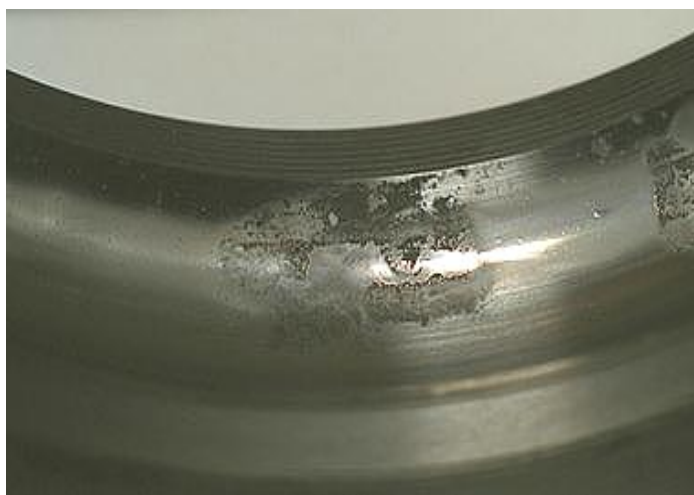
Figura 9.6 – Foto dos sulcos do rolamento danificado
