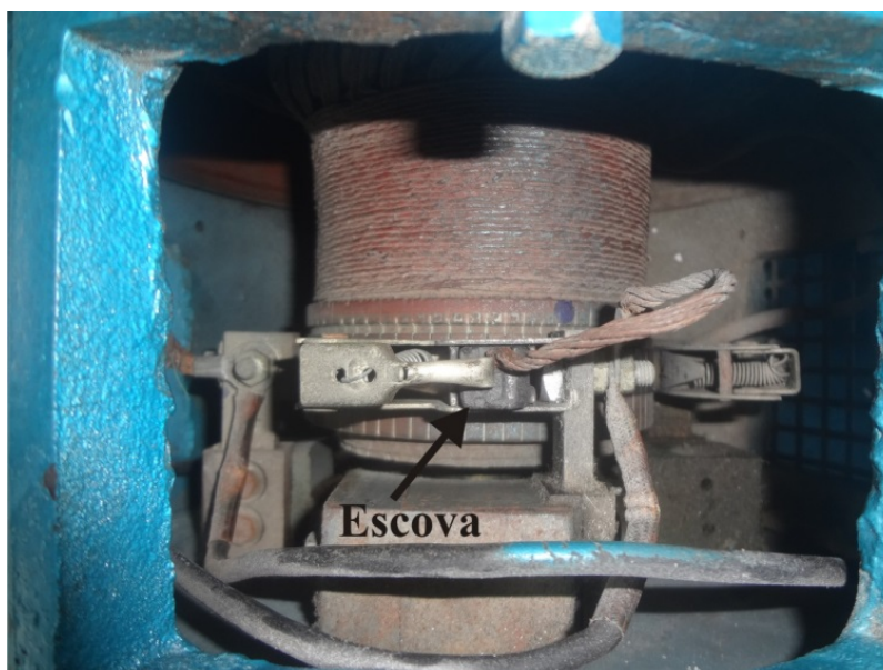
Figura 9.16 – Detalhe de uma escova de grafite em contato com as lâminas comutadoras numa máquina de 5 cv
