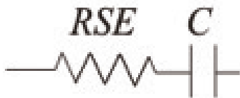
Figura 7.5 – Modelo simplificado do capacitor.
