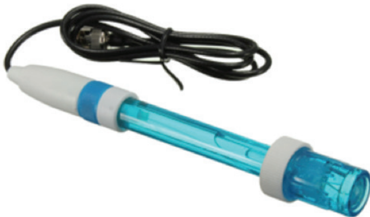
Figura 6.2 – Membrana de vidro em um eletrodo combinado.
