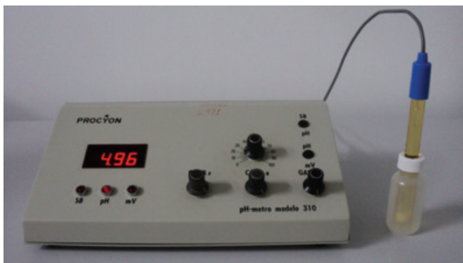
Figura 6.3 – Medidor de pH Procyon e o sensor de pH.
