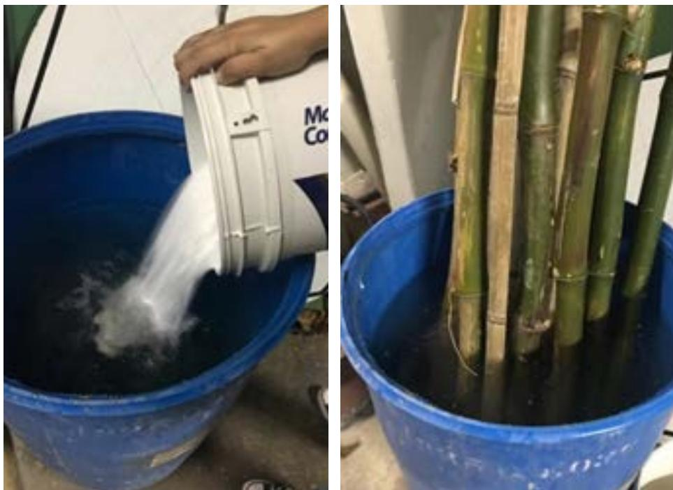
Figura 4 e 5 – Tratamento do bambu. Fonte: autores, 2019
