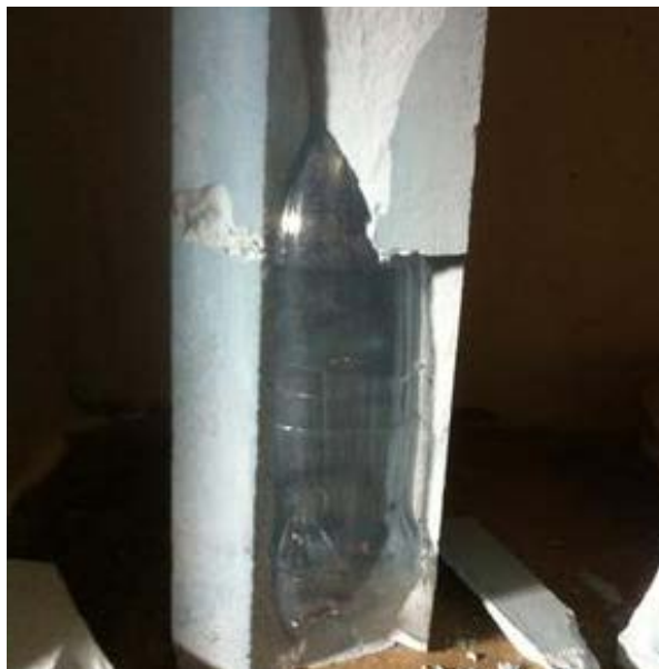
Figura 30 – Bloco de gesso com resíduos poliméricos
