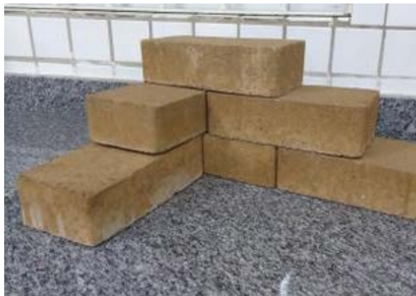
Figura 26 – Blocos de terra comprimida (BTC)
