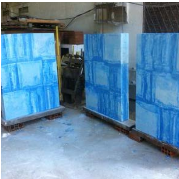
Figura 29 – Paredes de gesso com resíduos poliméricos
