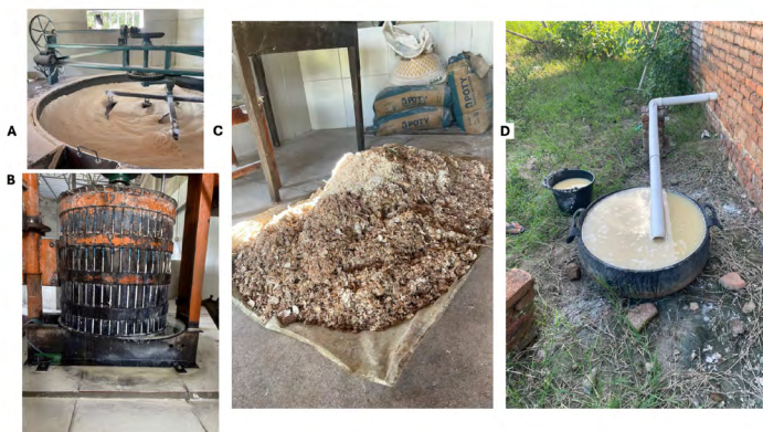
Casa de farinha: (A) produção da farinha durante a torrefação; (B) prensagem da mandioca para obtenção da manipueira; (C) resíduos da produção da farinha - cascas de mandioca; (D) resíduos da produção da farinha - manipueira Fonte: Divulgação
