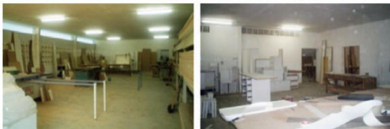
**Setor de acabamento** – está dividido em três áreas principais: lixamento e polimento das peças, aplicação dos produtos necessários ao acabamento e secagem das peças. A disposição dos elementos de produção apresenta-se inadequada, gerando desordem no espaço e um fluxo confuso. (Figura 7a).
