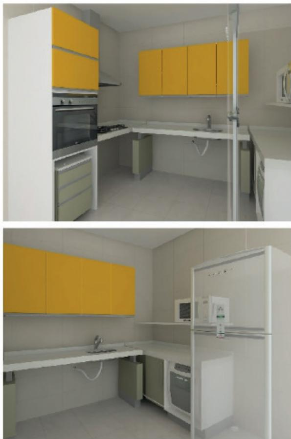
A proposição das bancadas elevatórias foi feita como forma de demonstração de mecanismos disponíveis no mercado para a adaptação de cozinhas à acessibilidade. Dessa forma, reforça-se, pelo custo dos equipamentos utilizados, a Proposta 3 como a adaptação com maior valor de implantação, porém como a de melhor adequação do ambiente ao usuário de cadeira de rodas.
