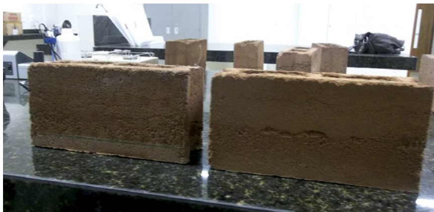
FIGURA 01 – Tijolos submetidos ao ensaio de eflorescência
