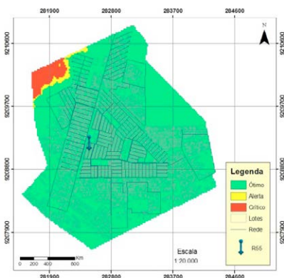
Figura 10 – Mapa representando a delimitação das zonas de pressão do reservatório R55, de acordo com os critérios estabelecidos
