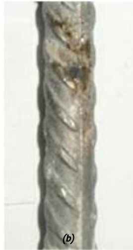
Figura 4 – Aparência superficial da corrosão generalizada desencadeada pela carbonatação do concreto (a) e da corrosão puntiforme desencadeada pela ação dos íons cloreto (b)
