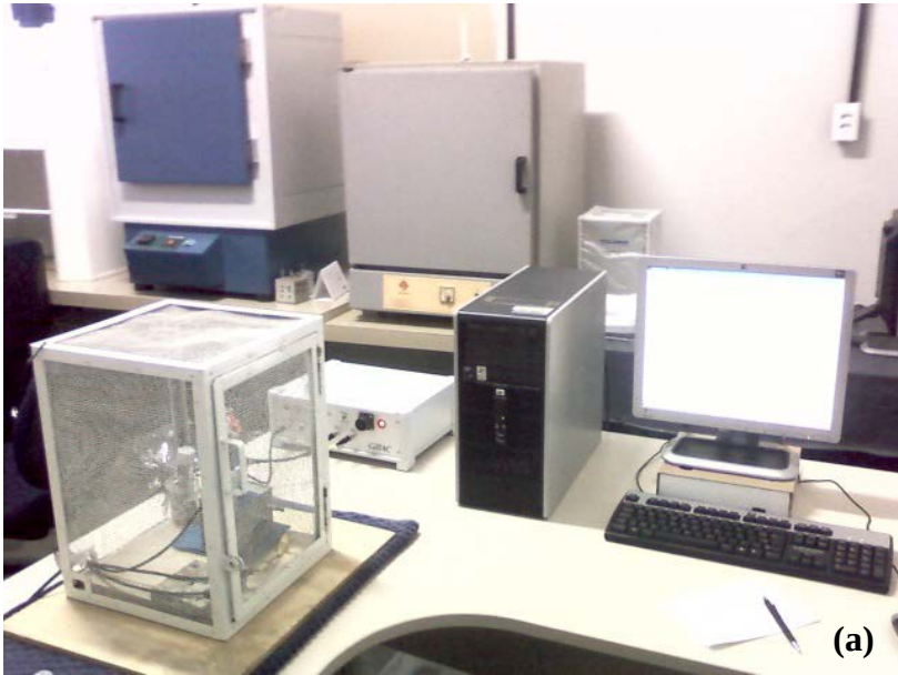
Figura 35 – Setup para a aplicação da técnica de R_p – vista geral (a), vista focada no corpo de prova e eletrodos (b)
