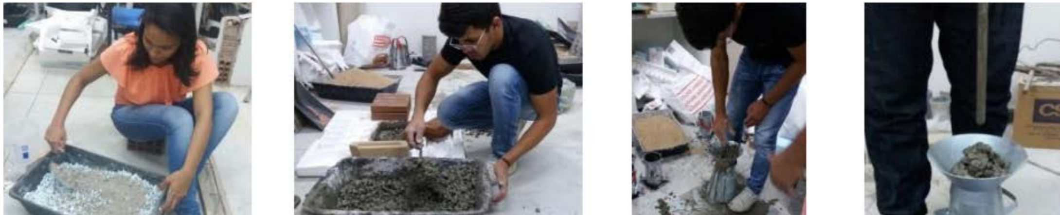
Figura 1. Preparação do concreto leve com agregado de EPS reciclado.
