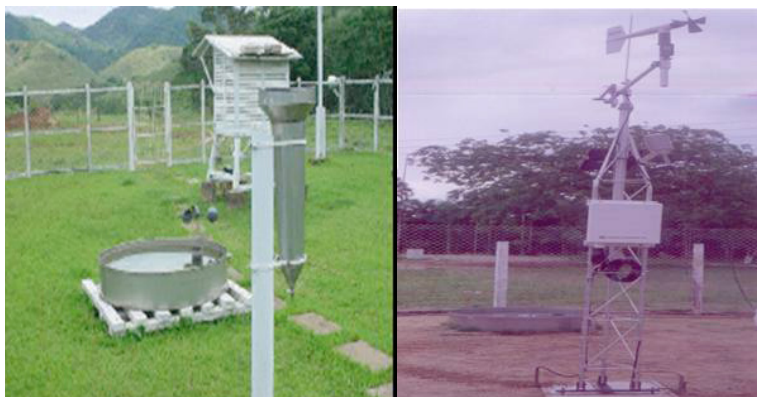
Figura 13 - Estações meteorológicas convencional e automática. Centro de Pesquisas do Cacau, Ilhéus, Bahia.
