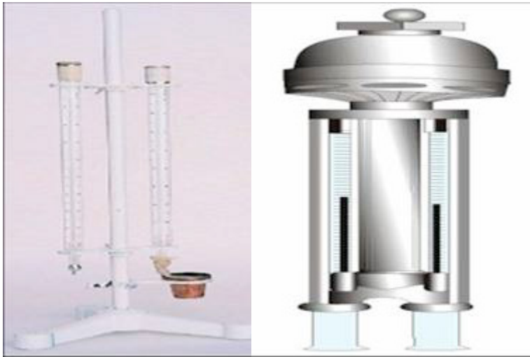
Figura 49 - Psicrômetros do tipo comum (direita) e aspirado do tipo Ashmann (esquerda) Fonte: Hermes Alves de Almeida/2014.
