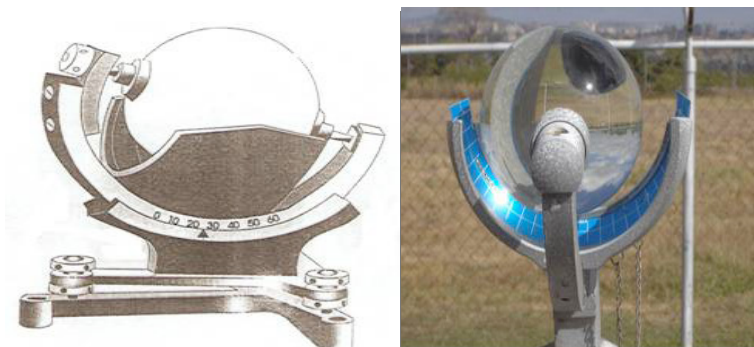
Figura 44 - Vista do heliógrafo Campbell-Stokes sem e com a fita helio-gráfica
