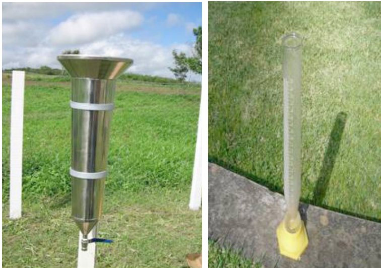
Figura 79 - Pluviômetro modelo Ville de Paris e proveta graduada em milímetro
