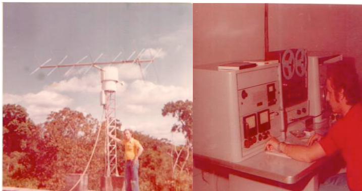
Figura 11 - Estação de recepção de imagens de satélites meteorológicos de órbita polar. Centro de Pesquisas do Cacau, Ilhéus, BA, em 1980 Fonte: Hermes Alves de Almeida/2014.
