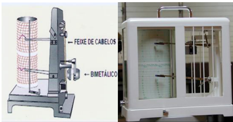
Figura 50 - Detalhes dos sensores de umidade (cabelos) e de temperatura (bimetalico) do Termohigrógrafo Fonte: M. A. Varejão-Silva/2001.
