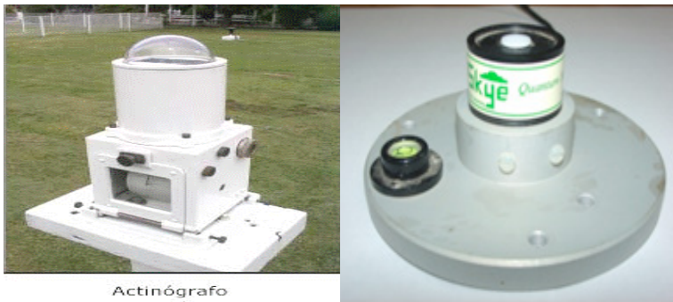
Figura 42 - Radiômetros para medidas de irradiância global, actinógrafo bimetálico de Robitzsch (A) e Eppley (B) Fonte: Hermes Alves de Almeida/2014.
