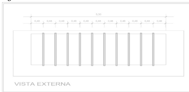
Figura 3: Vista externa dos brises verticais
