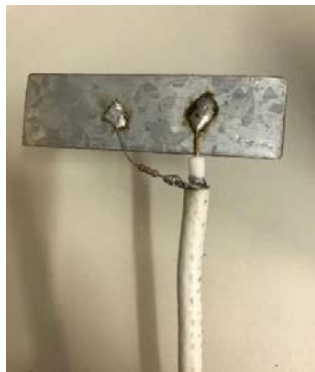
Figura 4 – Sensor capacitivo desenvolvido e utilizado no projeto
