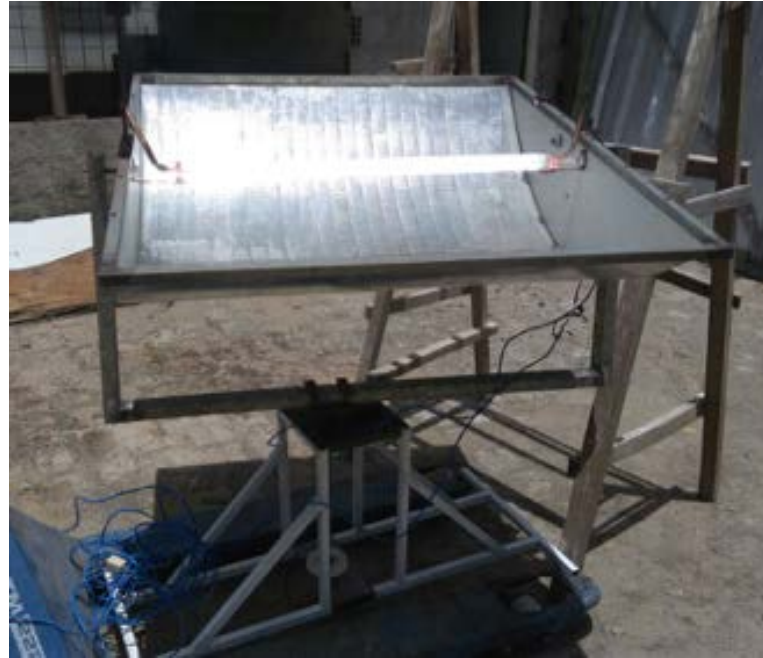
Figura 02 – Concentrador solar parabólico em funcionamento
