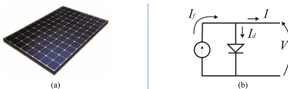
Figura 12.12 – (a) Pannel Fotovoltaico comercial monocristalino de 330 watts; (b) Modelo simplificado de um pannel fotovoltaico
