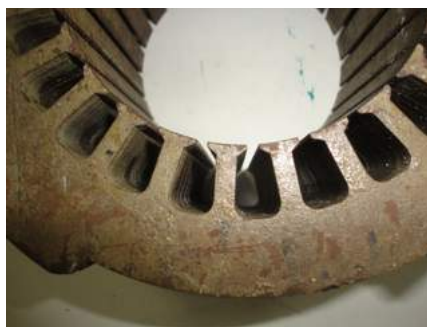
Figura 9.20 – Ranhuras para inserção das bobinas dos enrolamentos de uma máquina CA
