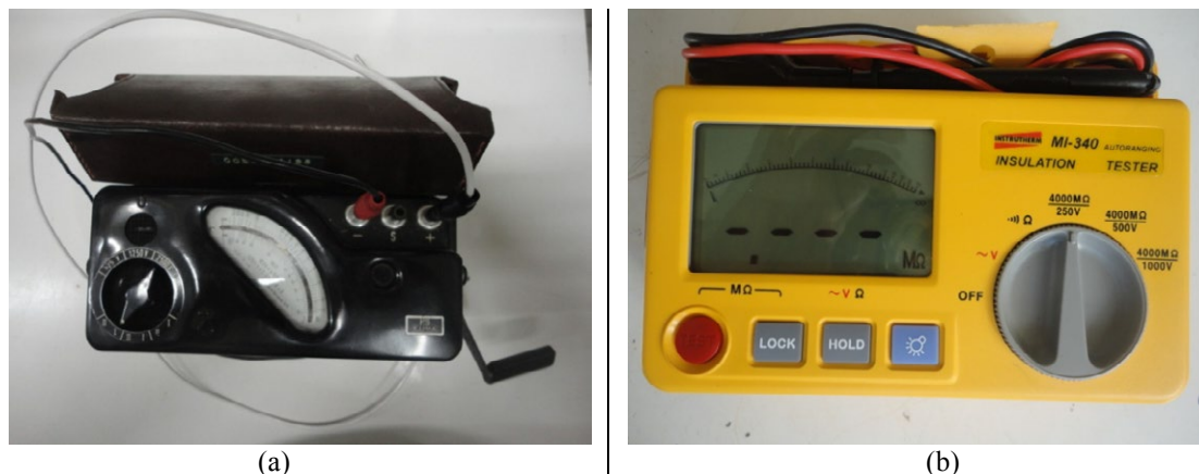
Figura 2.9 – Megômetro (a) analógico e (b) digital
