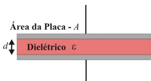
Figura 1.20 – Capacitor elementar formado de duas placas quadradas e um dielétrico
