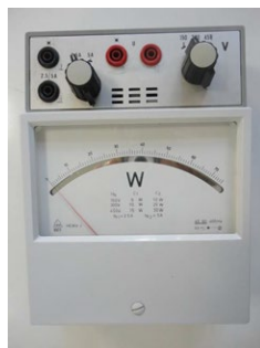
Figura 2.16 – Wattímetro do tipo analógico
