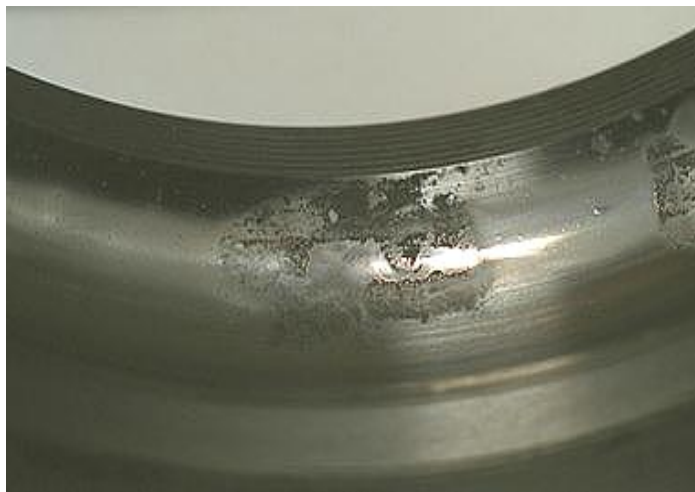
Figura 9.6 – Foto dos sulcos do rolamento danificado
