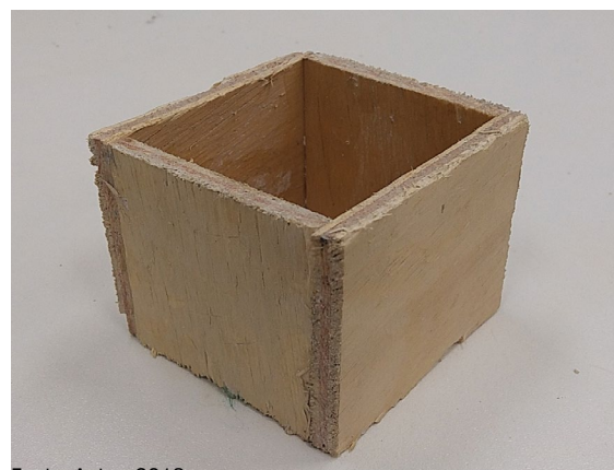
Figura 2 - Caixote de madeira utilizado para medir os volumes dos traços das argamassas
