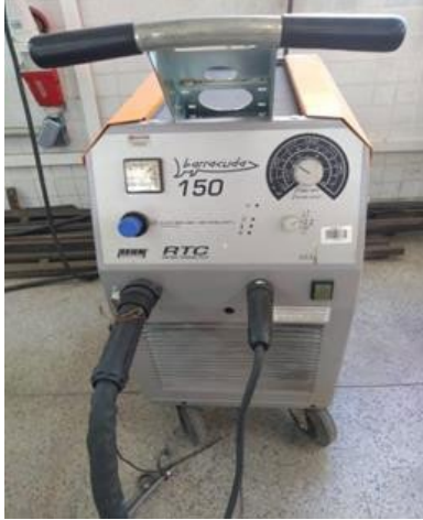
Figura 3 - Máquina de corte a plasma Barracuda 150 da REHM Welding Technology
