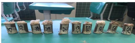
Figura 9 – corpos de provas com formação dos cristais.
