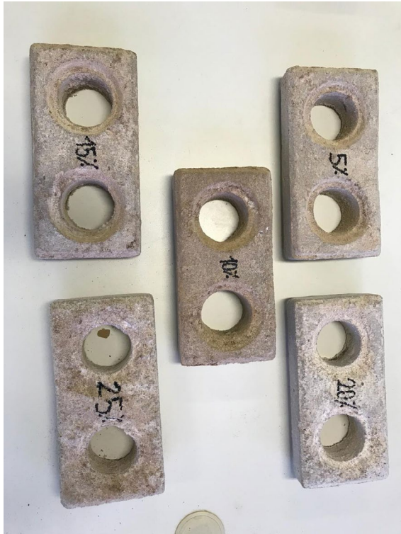
Figura 8 - Tijolo solo-cimento com adicional de resíduo cerâmico e hidróxido de sódio
