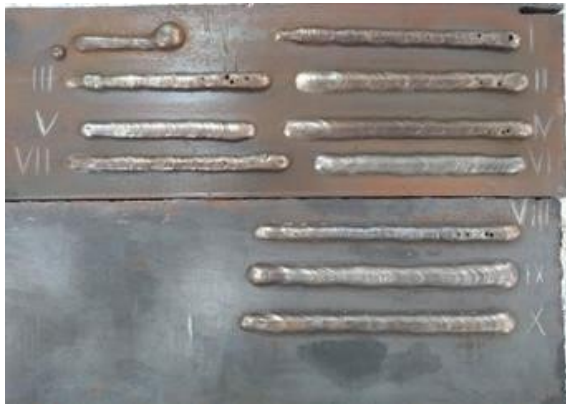
Figura 12: Cordões de solda
