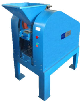
Figura 1- Etapas de Cominuição - Britador de mandíbulas.
