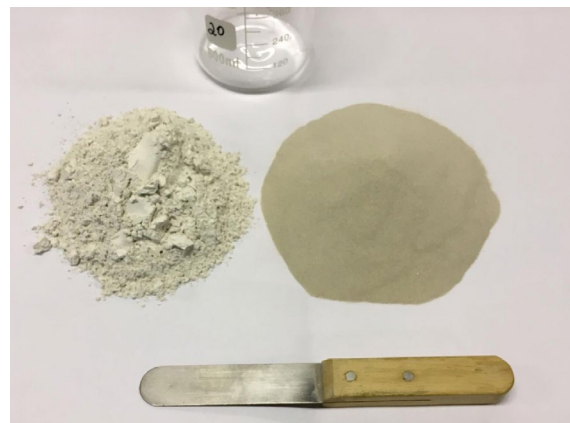
Figura 2 - Etapa de adição de Cal Virgem (CaO) nas amostras. Fonte: Autores (2019).
