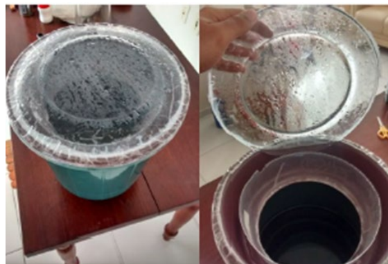
Figura 2 - Sistema de purificação de água da chuva por aquecimento solar.
