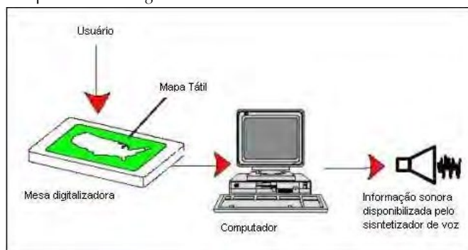
Figura 3: Esquema de funcionamento dos produtos cartográficos táteis
