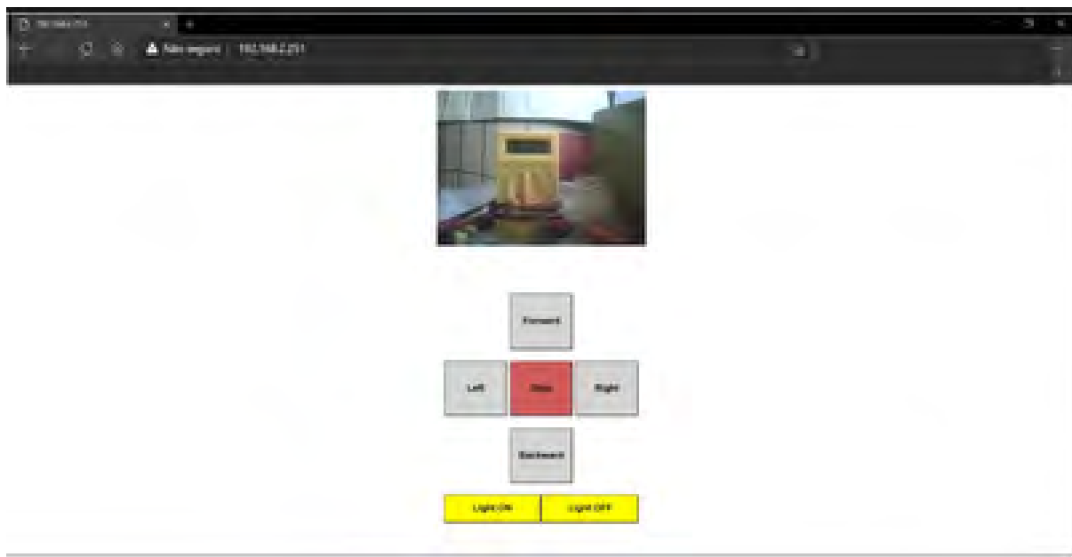
Figura 3: Painel de controle via web server com foco na visualização da câmera.
