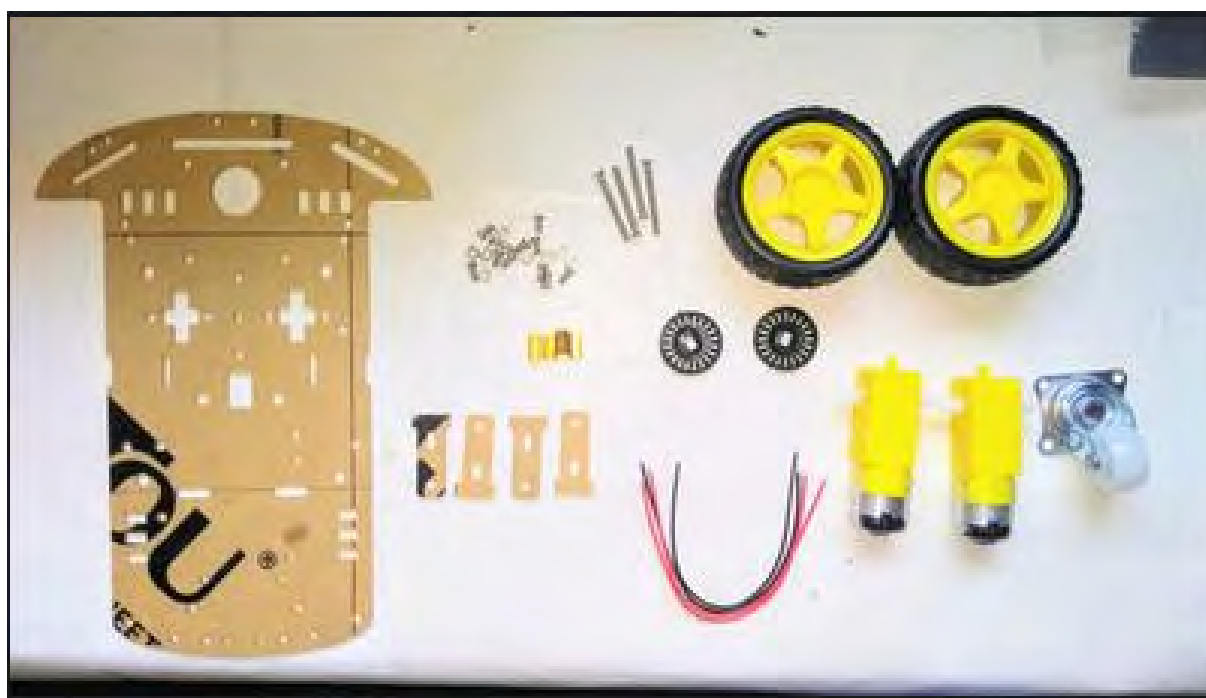
Figura 1: Componentes utilizados para a montagem do chassi.
