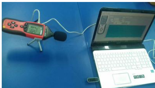
Figura 2 – Medidor de pressão sonora DEC 490 - Instrutherm conectado ao notebook com software
