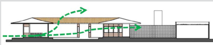
Figura 23 Corte esquemático com ventilação predominante, demonstrando a exaustão pelo vazio do pátio descoberto Fonte: ARCEN/PMJP. Desenhos de Roberta xavier da Costa, 2011
