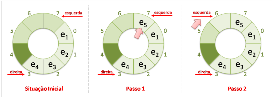
Figura 7.3 – Deque Estático - Inserir à Esquerda
