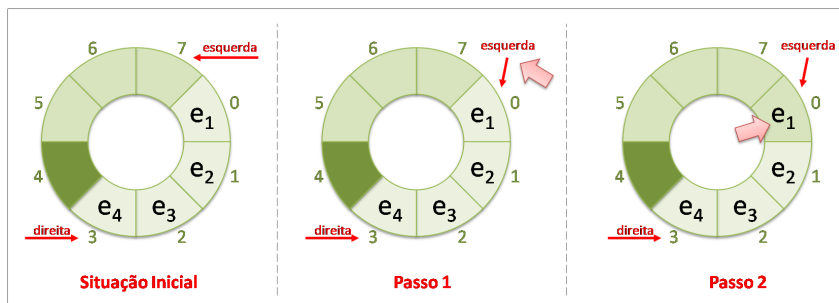
Figura 7.5 – Deque Estático - Remover à Esquerda
