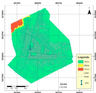
Figura 10 – Mapa representando a delimitação das zonas de pressão do reservatório R55, de acordo com os critérios estabelecidos
