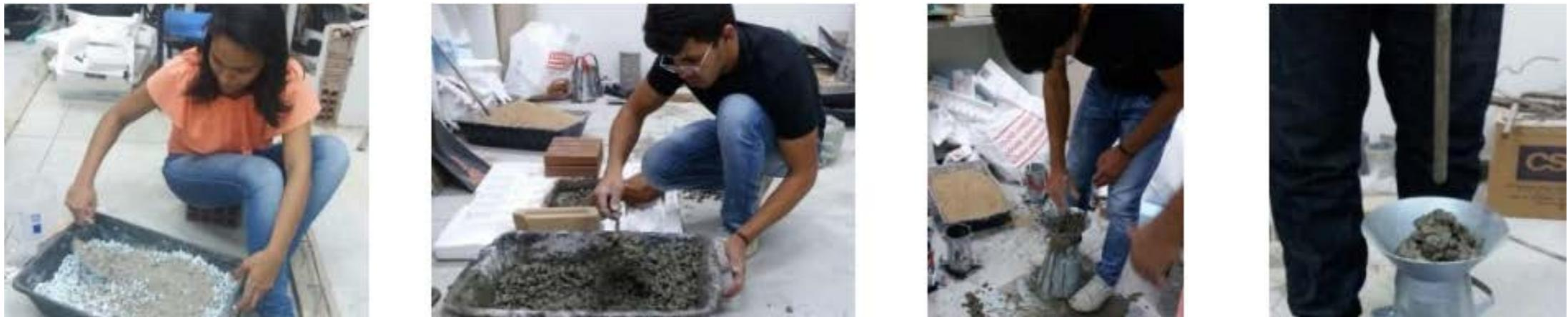
Todas as formas sejam elas as dos corpos de prova, formas de placas prismáticas, ou bloco de vedação, foram untados com óleo mineral para facilitar a desmoldagem. Após 24 horas de cura foi feito a desforma dos corpos de prova e realizada a cura.
