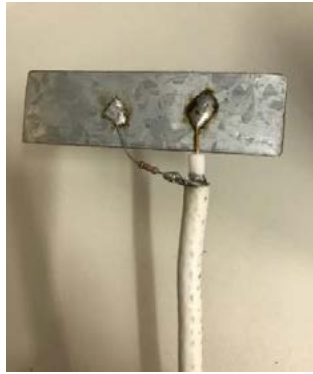
Figura 4 – Sensor capacitivo desenvolvido e utilizado no projeto
