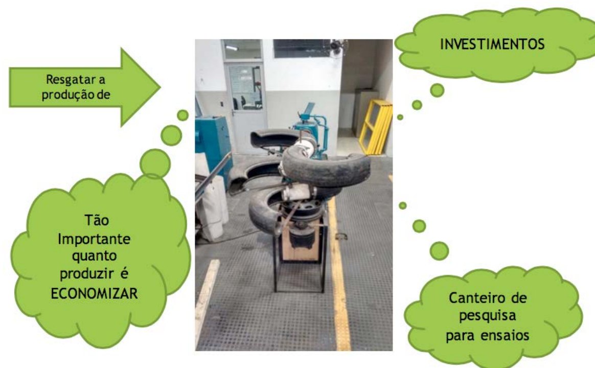
Figura 1 – Gerador eólico construído com reuso de materiais da indústria automobilística.
