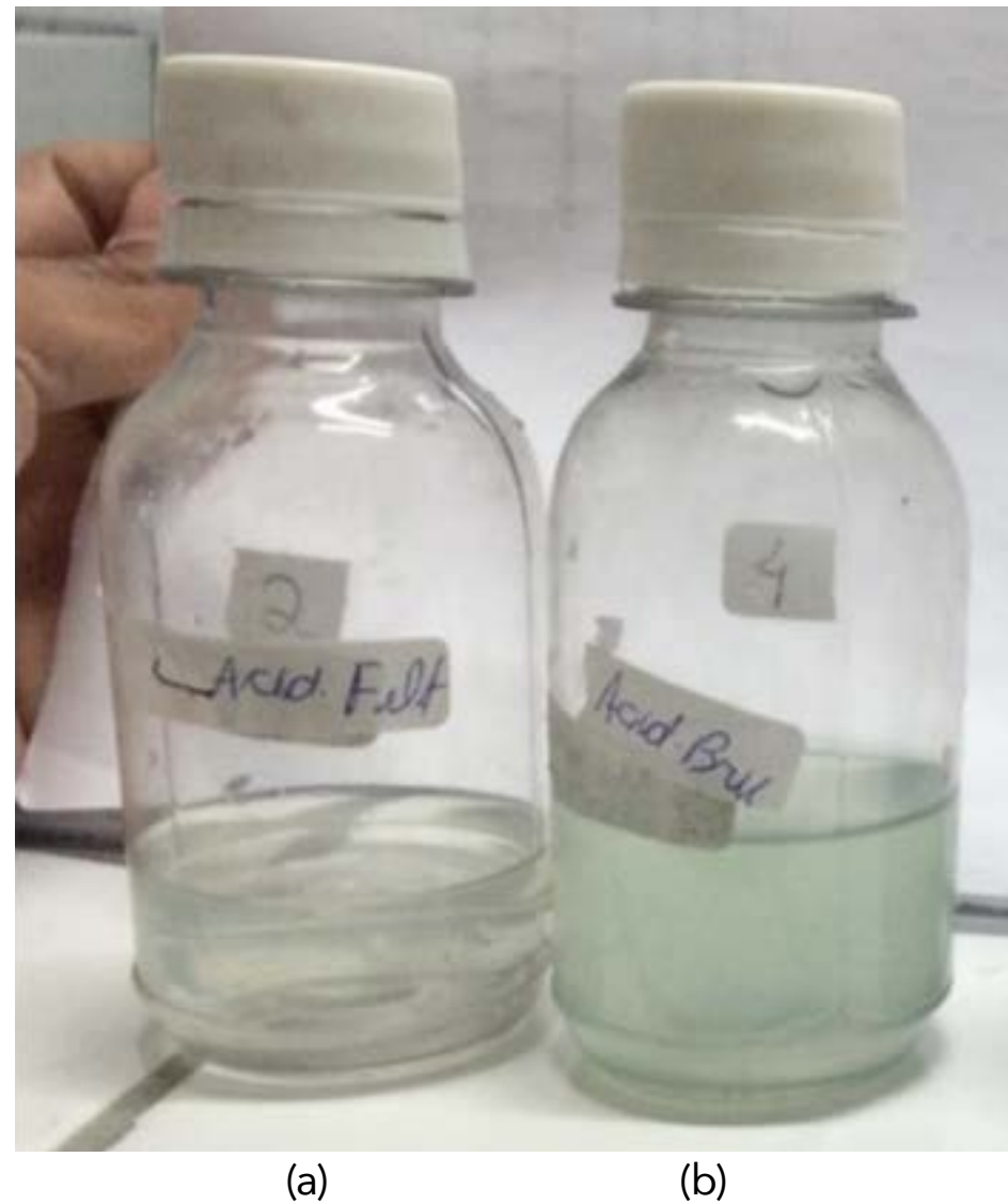
Figura 2- Foto de uma amostra de efluente antes (b) e depois (a) da degradação por fenton. Estes resultados sinalizam o processo fenton como procedimento promissor na degradação de contaminantes de efluentes têxtil.
