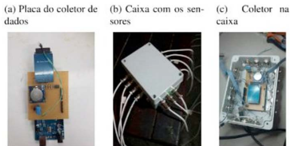
Figura 1 – Equipamento de medição para obtenção da temperatura nos diferentes pontos do Dessalinizador e de umidade ambiente.
